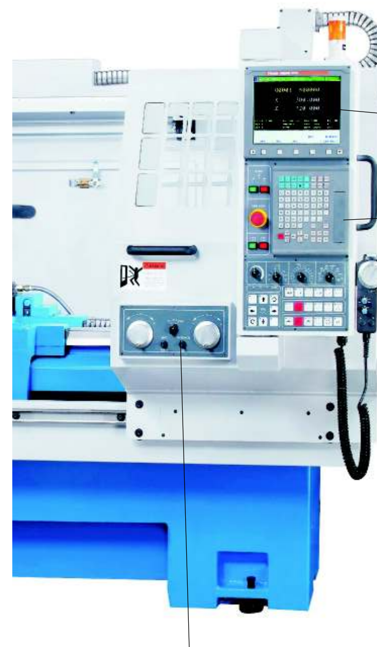
Due volantini elettronici per tornitura manuale Dual electronic handwheels for manual turning
