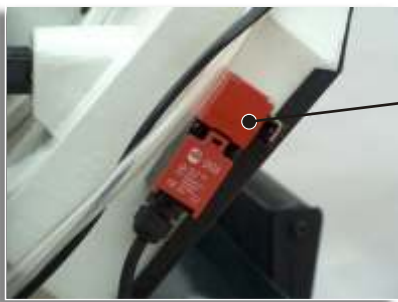
Micro di sicurezza sul carter Security micro on carter
