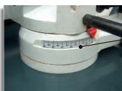
Scala graduata per inclinazione taglio Graduate scale for cutting inclination
