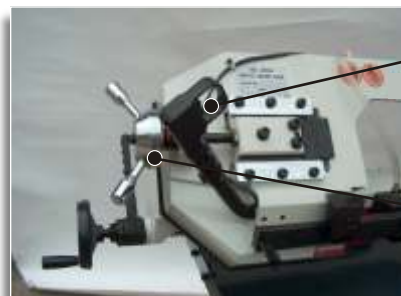
Tensionatore per lama Cutting blade tension Pulsante per avviamento lama Start blade switch
