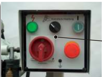
Pannello di controllo con selettore auto/manuale e emergenza Control panel with automatic/manual selector and emergency switch
