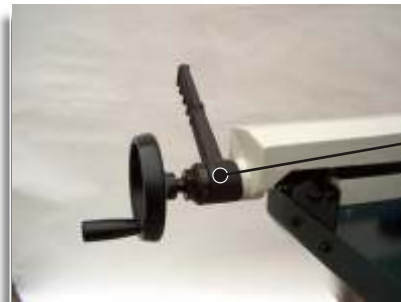
Micro di sicurezza sul carter Security micro on carter
